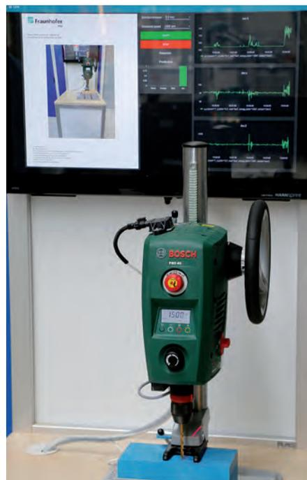
**Die Qualitätsprognosen mit Hilfe von KI können auf einem Bildschirm visualisiert und mitverfolgt werden (© Fraunhofer IWU)**
