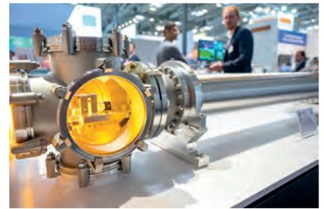
**Im Fraunhofer CAPS werden Hochleistungs-UKP-Laser für Industrie und Forschung entwickelt; im Bild eine Multipass-Zelle für die Nachkompression bei 2 µm Wellenlänge** (© Fraunhofer/Markus Jürgens)
