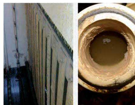
**Aufgrund von Oxalatbildung entstehen stark störende Beläge auf Anoden und Rohrleitungen, die in Kontakt mit alkalischen Zink-Nickel-Elektrolyten in Kontakt stehen**
