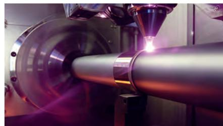
**Insbesondere beim Auftragen von schwer zerspanbaren, hochfesten Beschichtungen ergeben sich durch das neue Verfahren zum simultanen Beschichten und Zerspanen (SMaC) erhebliche wirtschaftliche und technologische Vorteile** (© Fraunhofer ILT, Aachen)
