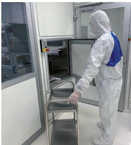
**Die Ausgabe der gereinigten Linsensysteme erfolgt in einen Reinraum, in dem vor der Montage eine 100-%-Kontrolle stattfindet**
