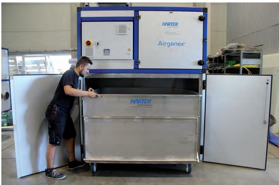
1,5 m<sup>3</sup> Kunststoffgranulat werden innerhalb von sechs Stunden bei 40 °C homogen auf eine Restfeuchte von weniger als 3 % getrocknet
