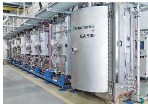
**ILA 900 - Vertikale In-line-Sputteranlage zur Beschichtung von Flachs substraten, unter Reinraumbedingungen, mit einer Magnetronlänge von 900 mm** (© Fraunhofer FEP)
