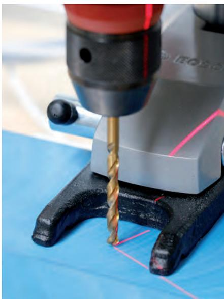
**Messedemonstrator des Fraunhofer IWU auf der Automatica: Die KI erkennt zum Beispiel auch bei Verbundmaterialien, wann in Holz oder Kunststoff gebohrt wird. Dies kann genutzt werden, um Prozessparameter online KI-gesteuert anzupassen (© Fraunhofer IWU)**
