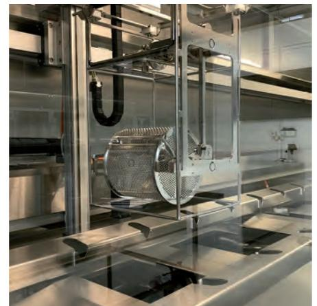
**Das spezielle Transportgestell kann bei Nassprozessen mit bis zu 500 und bei Trockenprozessen mit bis zu 1500 Umdrehungen pro Minute um die vertikale Achse gedreht werden**
