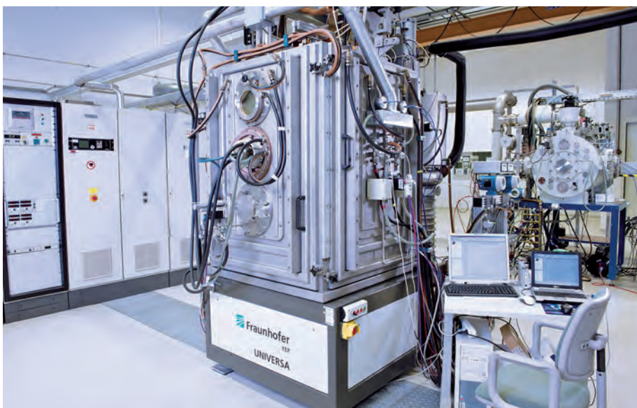
Batchanlage UNIVERSA des Fraunhofer FEP, mithilfe derer die magnetron-gesputterten Metalloxidschichten hergestellt wurden (© Fraunhofer FEP)
