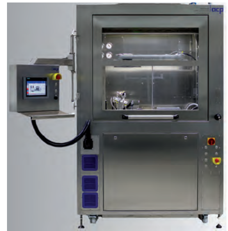
Die trockene Lösung für die Endreinigung der Öldruckleitung wurde in eine Standardzelle integriert, die unter anderem den Vorteil bietet, dass kein Abwasser anfällt, das entsorgt werden muss (Bild: acp systems)
