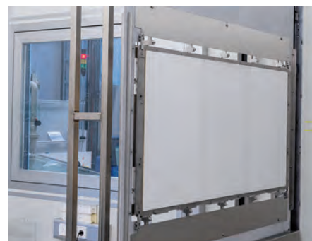
Abb. 3: Elektrostatischer Chuck mit 700 µm dickem Dünnglas zur großflächigen Sputterbeschichtung 600 × 1200 mm 2 an der ILA 900 (Bild: Fraunhofer FEP)
