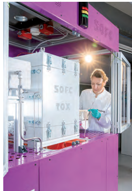
Demonstrationsanlage zur \text{CO}_2 -freien Stromerzeugung mit Ammoniak in Hochtemperatur-Brennstoffzellen (SOFC) © Fraunhofer IKTS
