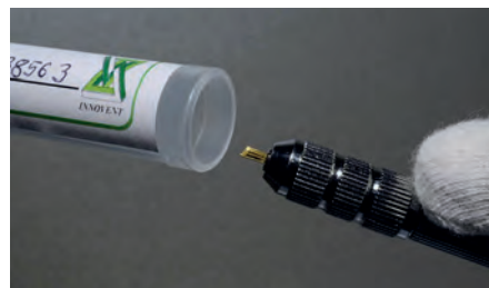
Abb. 1: Technisches Wattestäbchen zur Probennahme auf Oberflächen; hierzu wird die Spitze des Stifts über die Oberfläche geführt und nimmt dabei die dort vorhandenen Verunreinigungen auf, die anschließend analysiert werden
