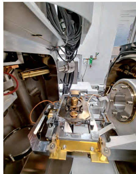
Blick auf die Probenkammer des geöffneten Röntgenmikroskops (Nano-CT)
