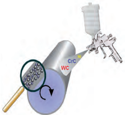
Abb.3: Spritzprozess für das BrazeCoat-S-Verfahren
