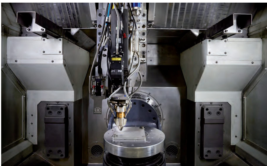
Versuchsanlage im H2GO-Projekt: Das Fraunhofer ILT beschichtet auf einer EHLA-Anlage Bauteile für Brennstoffzellen schnell und präzise mit Verschleißschutzschichten, um den Einstieg in die Großserie vorzubereiten (© Fraunhofer ILT, Aachen)
