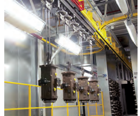
Einführung eines zukunftsfähigen Lackierprozesses bei LHY Powertrain: von der Förder-technik über die Lackapplikation bis zur Trocknung (Bild: LHY Powertrain GmbH & Co. KG)
