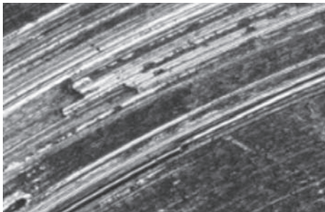
Abb. 8: Riefen und Partikelbildung in Folge Abrasionsverschleiß
